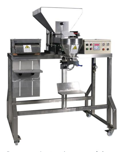
Dosatore semi-automatico per granulari con saldatrice per buste semi - automatic doser for granular products with pouches sealer
